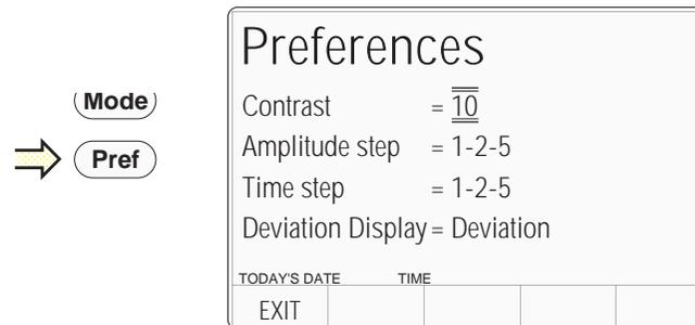
Fig. 3.3.2 'Pref' Parameters
