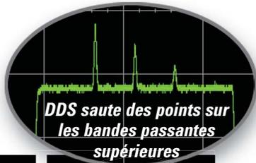
La technologie de la synthèse numérique directe peut sauter des points à des fréquences plus élevées. La technologie Trueform ne manque jamais de points et est en permanence lissée.
