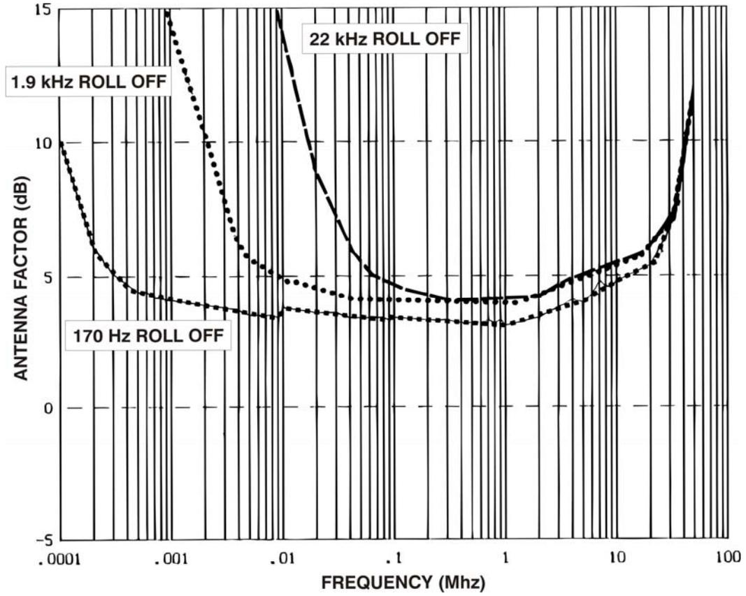
**TYPICAL ROLL OFF CURVES—41" ROD ANTENNA, 10 DB ATTENUATION**
