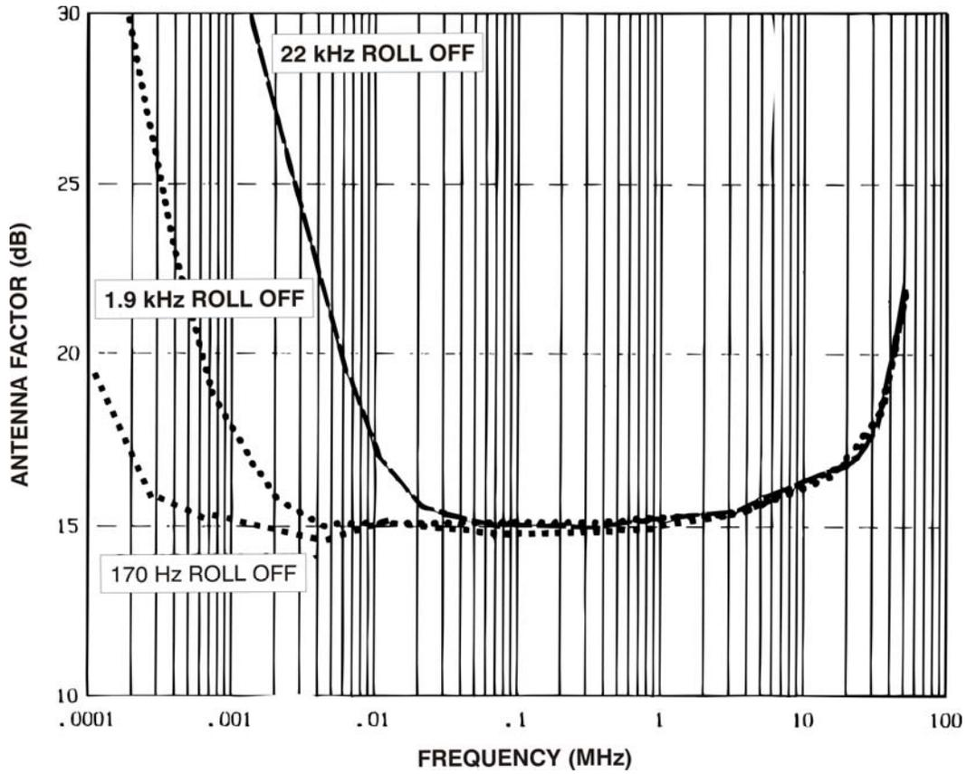
**TYPICAL ROLL OFF CURVES—41" ROD ANTENNA, 30 DB ATTENUATION**
