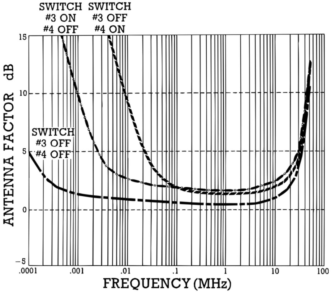
**TYPICAL ROLL OFF CURVES—41" ROD ANTENNA, 0 dB ATTENUATION**
