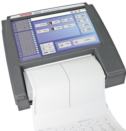
Le Sefram 8460 est un système d'acquisition de données avec tracé thermique (270mm). Vous pouvez définir toutes les caractéristiques de l'impression, telles que le mode d'impression f(t) ou XY, la vitesse de défilement papier (1mm/h à 100mm/s), le nombre de diagrammes ou bien le choix des réticules.
