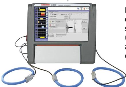
Les mesures sont réalisées en utilisant les entrées tension (directes) de la carte universelle et des pinces accessoires (flexibles ou conventionnelles)
